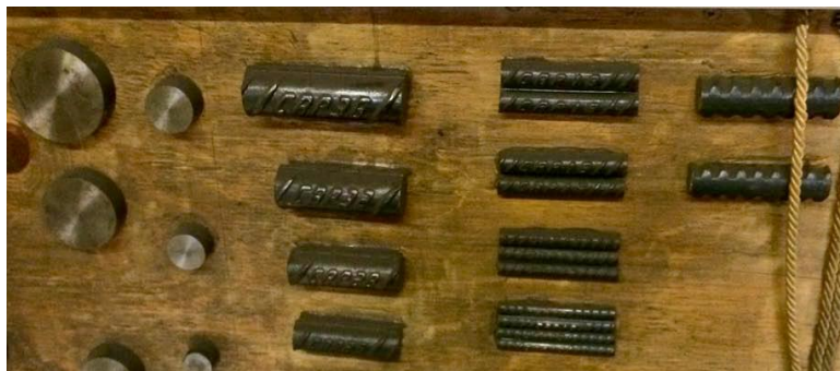
Figura N° 3 Diámetros de barras obtenidas en LBR. Fuente: CAP Acero, 2016.
