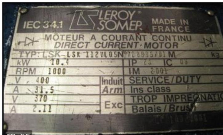
Figura 37. Placa del moto-reductor [31]
