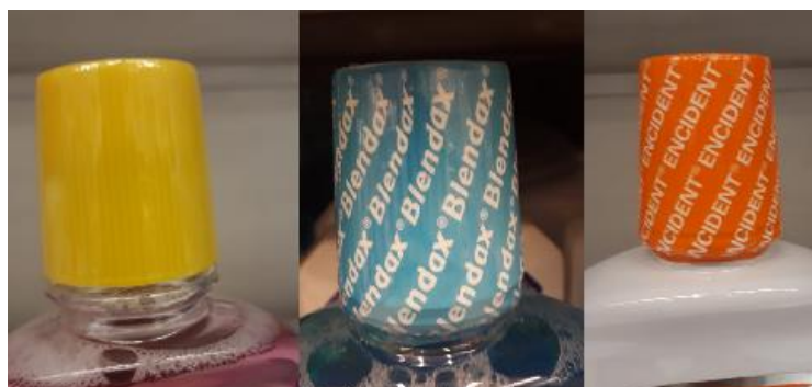
Figura 4.5 Frascos sellados a la temperatura dentro del rango
