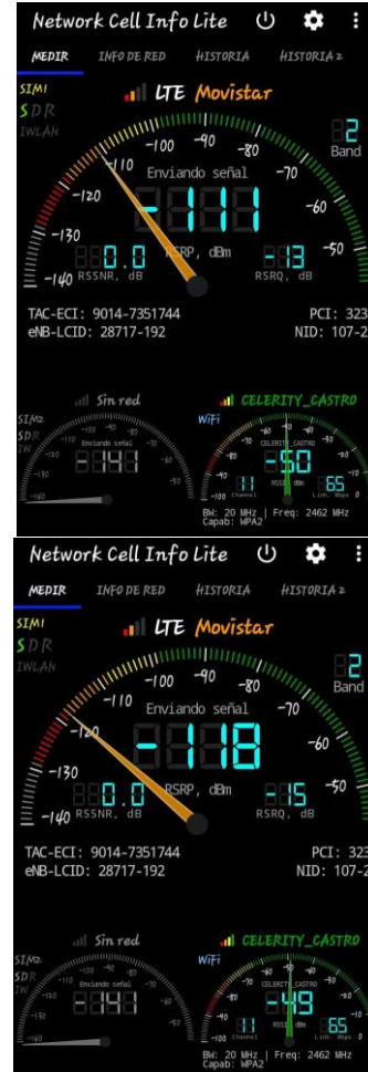
Figura 3. Sensibilidad medida a través de la aplicación Network Cell Info en un celular Samsung conectado a una red LTE Movistar.
