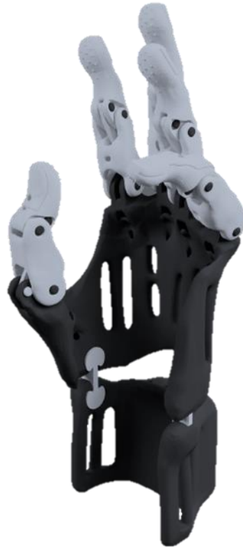
Figura 3.2 Mano mecánica impresión 3d
