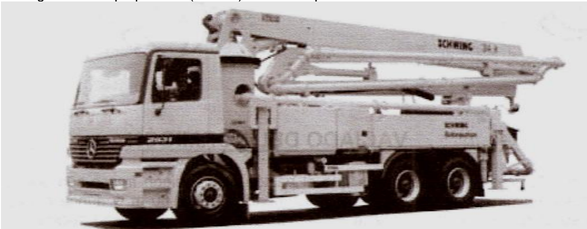
Grúa para bombeo. Altura: 34 mt aproximadamente 12 pisos.
