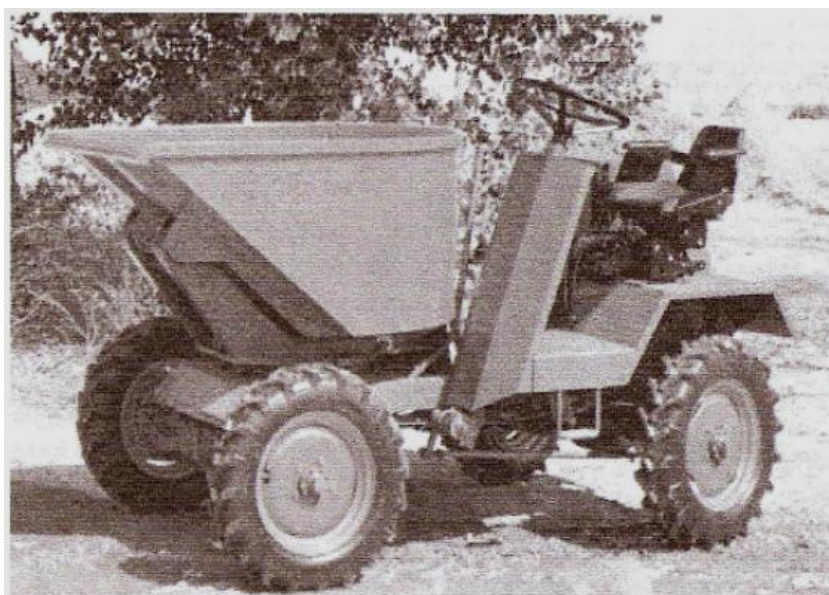
Motovolquete de descarga frontal. Capacidad: 150 lts
