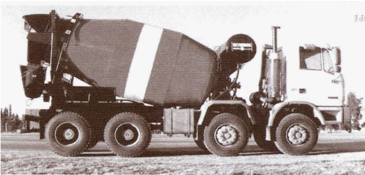
Hormigonera Autopropulsada ("Mixer") 9 m 3 de capacidad
