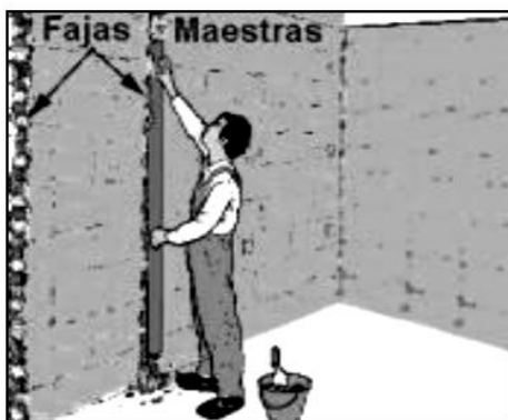
Realizar FAJAS verticales de mortero entre bolines, alisando con la regla de modo tal de establecer una guía para ejecutar el revoque.
