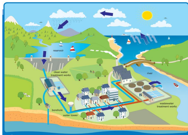
Figura 5 - Ciclo Integrado do Uso da Água - Fonte: Anglian Water Company
