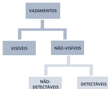
Figura 7 - Classificação dos Vazamentos. Fonte: Adaptado de SABESP (2017)
