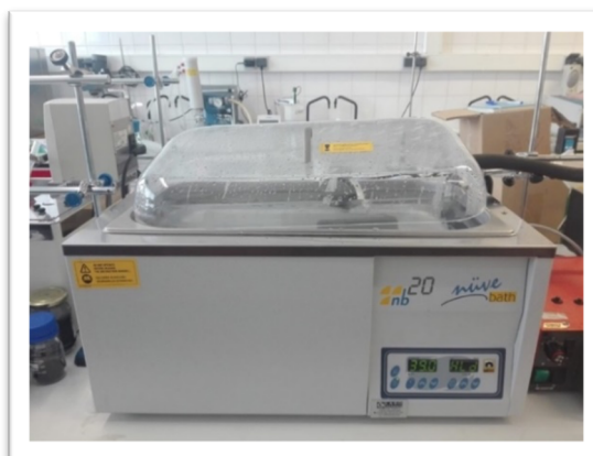
Figura 2.4. Banho de aquecimento de água ( Nüve bath , modelo NB 20) que alimenta o sistema de aquecimento do biorreator.
