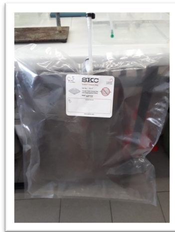
Figura 2.8. Recolha de biogás em sacos Tedlar de 10 L.
