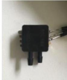
**Figura 3.14 – Sensor diferencial de pressão MPXV5004DP (utilizado como sensor de nível).**
