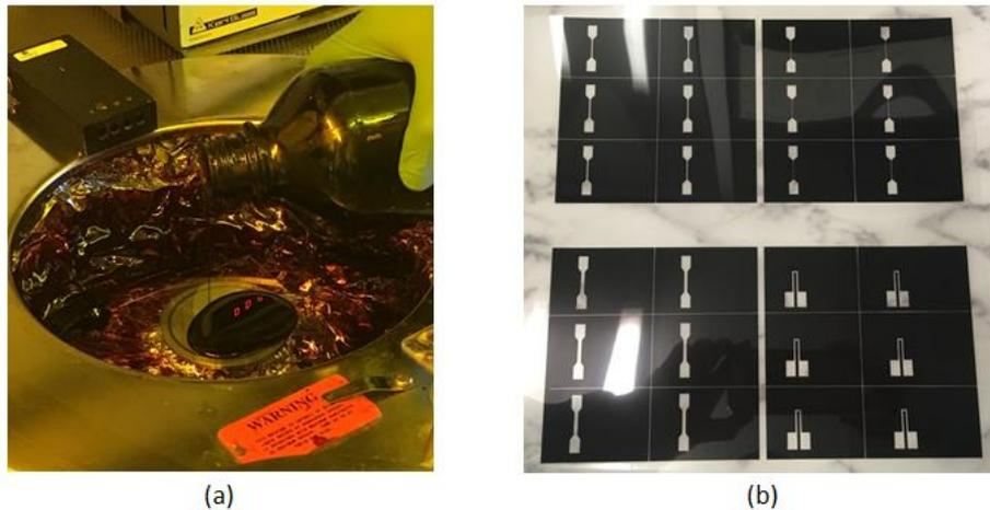
**Figura 4.5 – Preparação do substrato para a deposição do metal: revestimento do substrato com o fotoresiste AZ6632 através da técnica “*Spin coating*” em (a) e máscara de acetato com os desenhos dos filmes finos a depositar no vidro em (b).**
