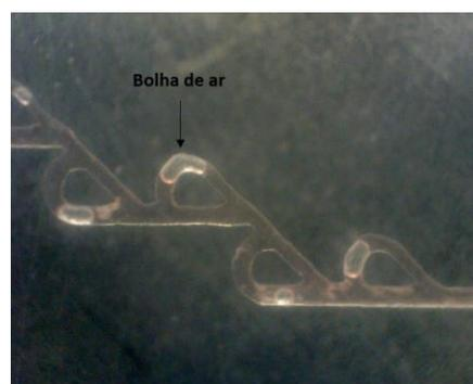
**Figura 5.11 – Imagem microscópica das válvulas de entrada/saída da Peça 3.**
