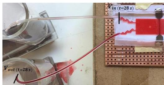
**Figura 6.13 – Sistema TV3-CAM associado ao filme DF2: após 3 ciclos de evaporação-condensação da água (t=28 s).**
