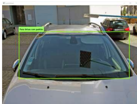
Figura 4.6: Outro vidro com o padrão presente identificado pelo YOLO.
