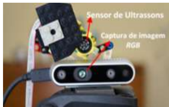
Figura 3.2: Combinação dos sensores Intel RealSense e TeraRanger DUO .
