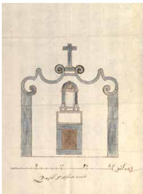
Fig. 12. Frei Pedro da Conceição (1677-1745), Fonte Nova. ADB, Convento de Nossa Senhora do Carmo de Viana do Castelo , PT/UM-ADB/MON/CNSCVCT/C49-1043. Legenda: Planta do Arco da fonte /prefil p. a a fonte nova O desenho tem escala de 0 a 20 palmos. (Direitos da imagem: © Universidade do Minho/Arquivo Distrital de Braga).
