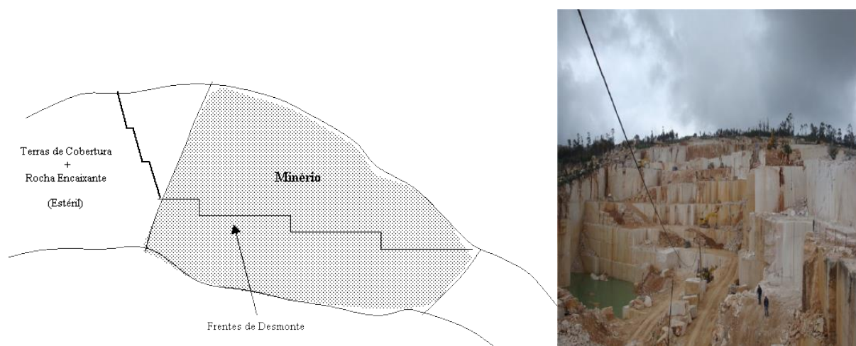
Figura 2.9 - Método de desmonte: Flanco de encosta, simplificação à esquerda (IGM, 1999) e fotografia à direita (Nunes, 2010)
