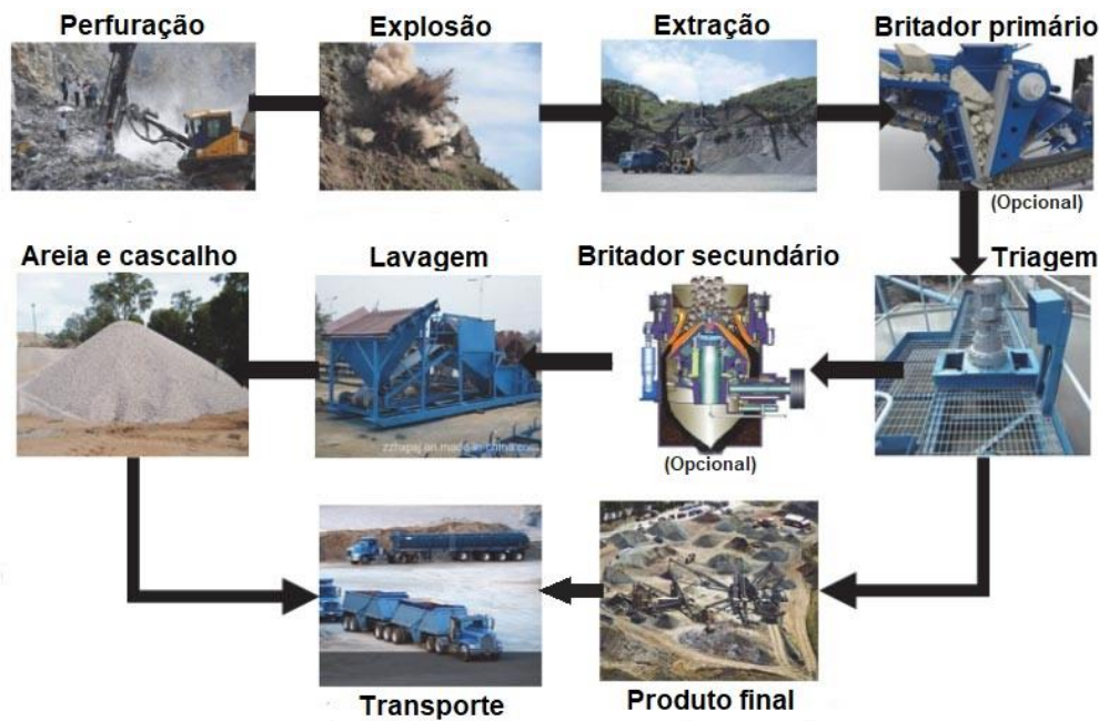
Figura 2.12 - Processamento dos agregados (NBM&CW, 2019)
