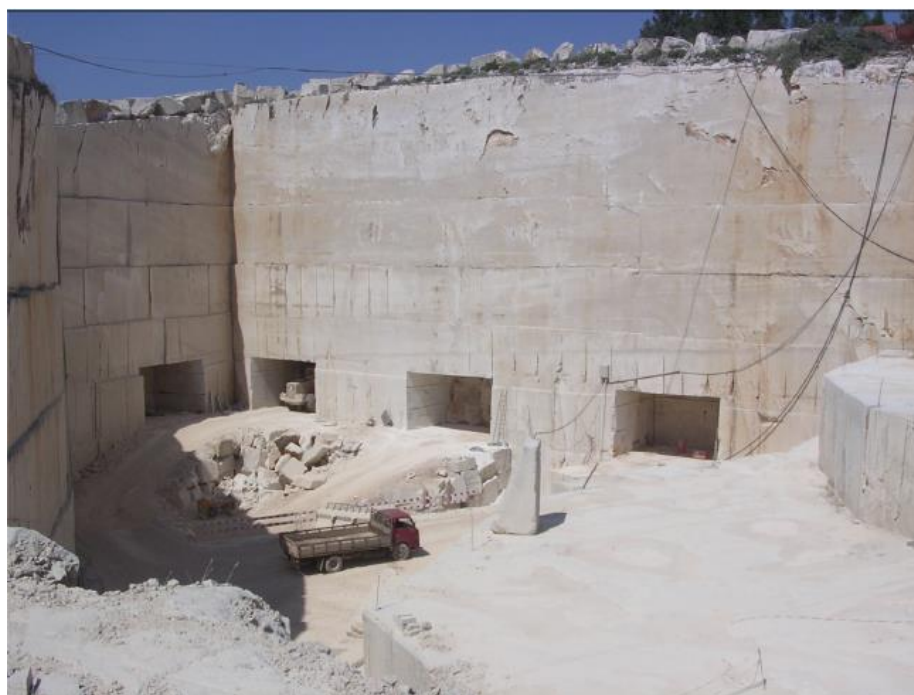
Figura 2.11 - Método de desmonte: Câmara e Pilares (Nunes, 2010)
