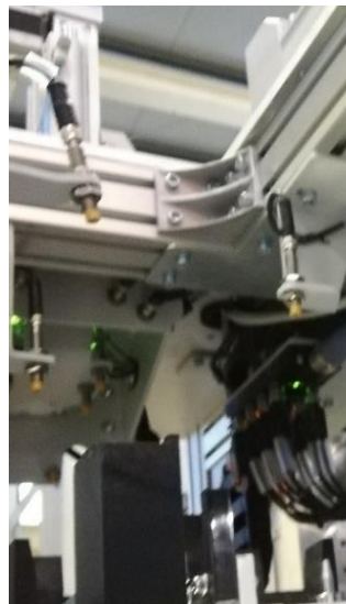
Figura 107. AG38-BJHT - Controlo de presença de inserto
