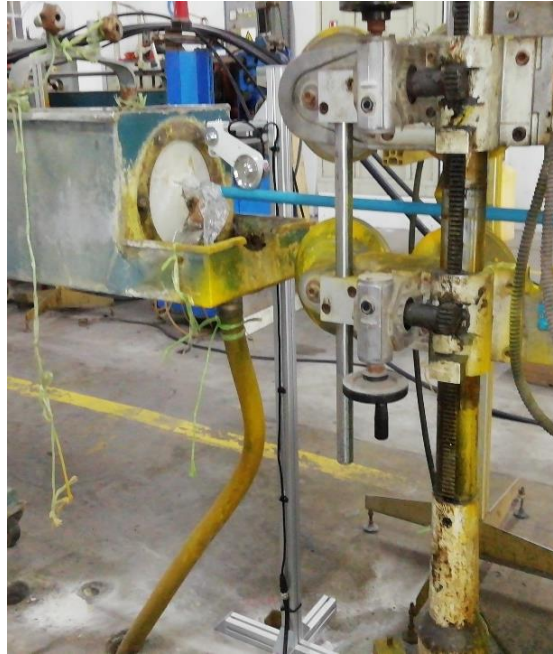
Figura 88. Suporte de encoder instalado AM13
