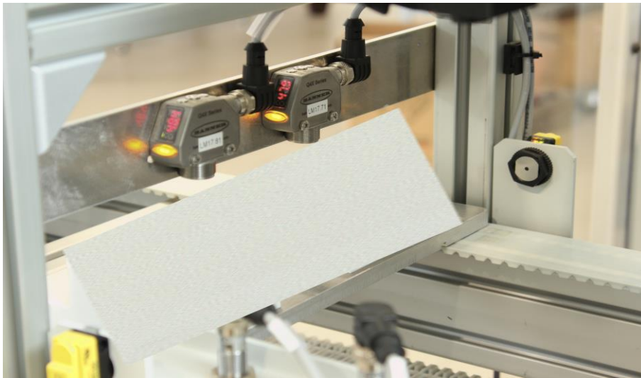
Figura 93. AG35-ROCKER - Controlo gito com medição laser
