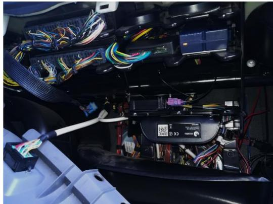
Figura 40 – Stratio Databox instalado no quadro elétrico de um camião (Stratio).
