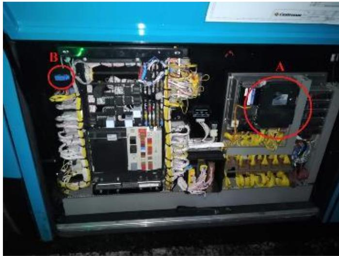
Figura 23 – Quadro elétrico de autocarro urbano (Stratio).
