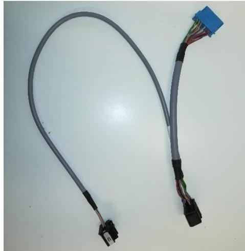
Figura 38 – Cabo de comunicação do Stratio *Databox* (Stratio).
