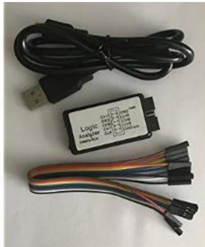
Figura 28 – Analisador de lógica de oito canais (Amazon).
