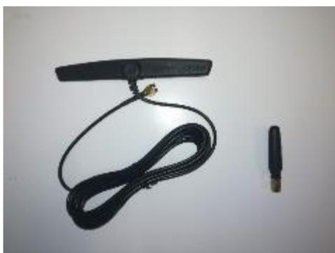
Figura 36 – Antenas GPRS do Stratio Databox (Stratio).
