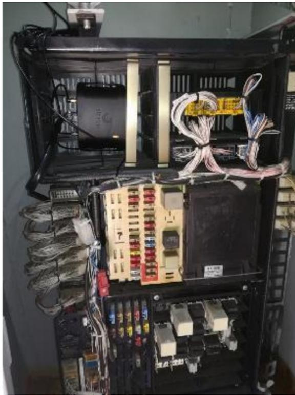
Figura 41 – Stratio Databox instalado no quadro elétrico de um autocarro (Stratio).
