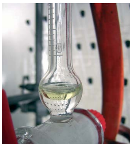
Extração de óleo essencial de conteira no DCTD por hidrodestilação
