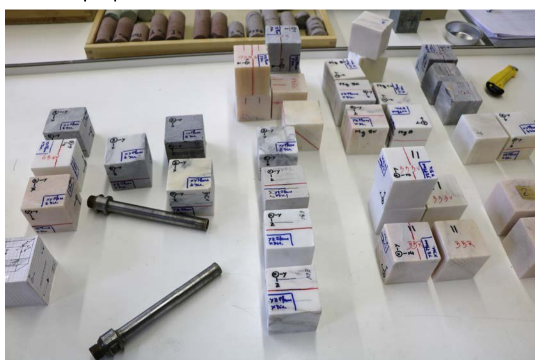
Figura 1 - Provetes preparados para ensaio, com a foliação devidamente marcada.
