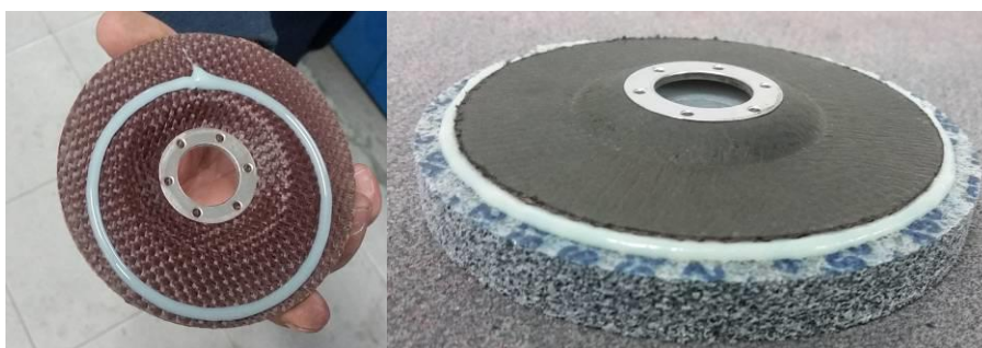
Figura 15 - Prato e disco com aplicação incorreta de cola
