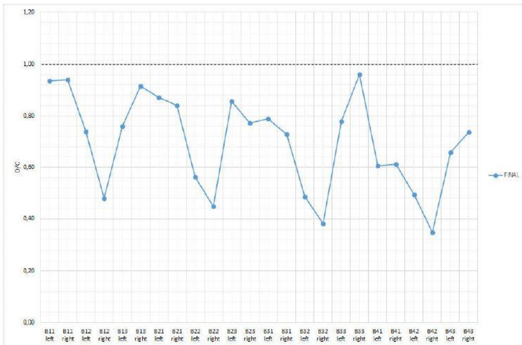
Fig. 39 - Rátios dos valores nas vigas da força de corte para a solução final, [31].
