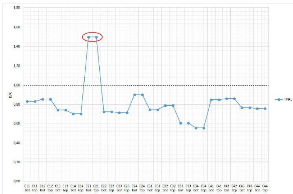
Fig. 38 - Rátios dos valores nos pilares da força de corte para a solução final, [31].
