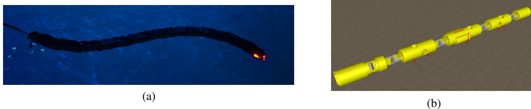
Figura 2.6: Robôs Multissegmento Subaquáticos: 2.6a é uma figura do robô Mamba em testes, retirado de [17], e 2.6b mostra uma simulação de um manipulador subaquático nadante [18].
