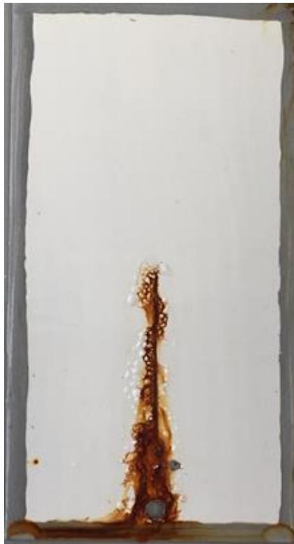
Esmalte G após 170 horas em nevoeiro salino
