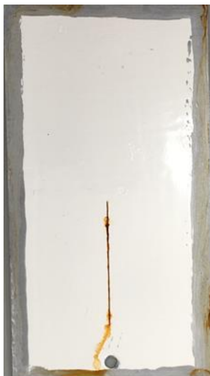
Esmalte Padrão após 170 horas em nevoeiro salino.
