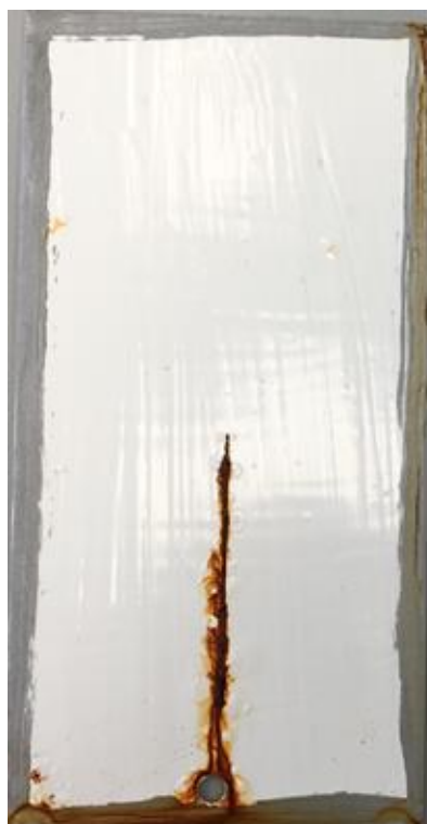
Esmalte Concorrência 1 após 170 horas em nevoeiro salino.
