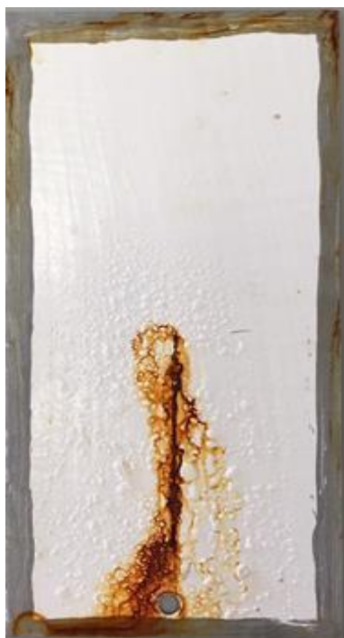
Esmalte A após 170 horas em nevoeiro salino
