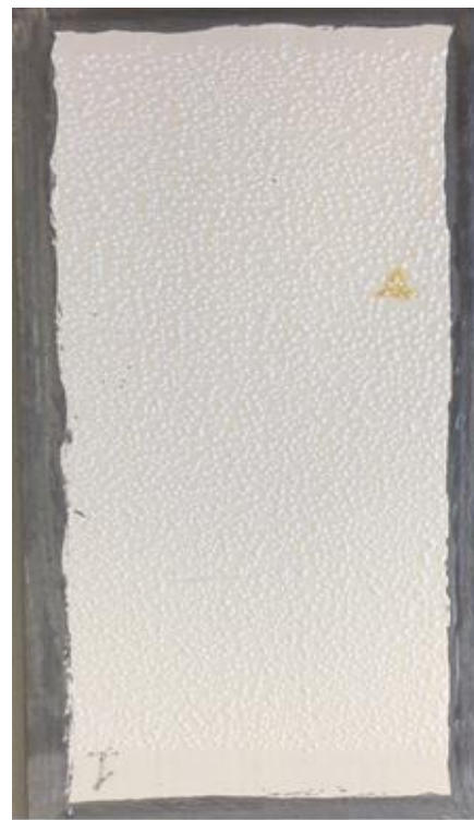
Esmalte Concorrência 3 (C3) após 170 horas em câmara de condensação
