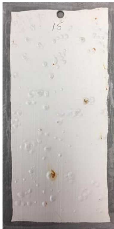
Esmalte F após 170 horas em câmara de condensação
