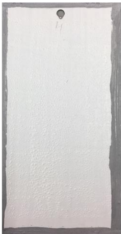
Esmalte C após 170 horas em câmara de condensação
