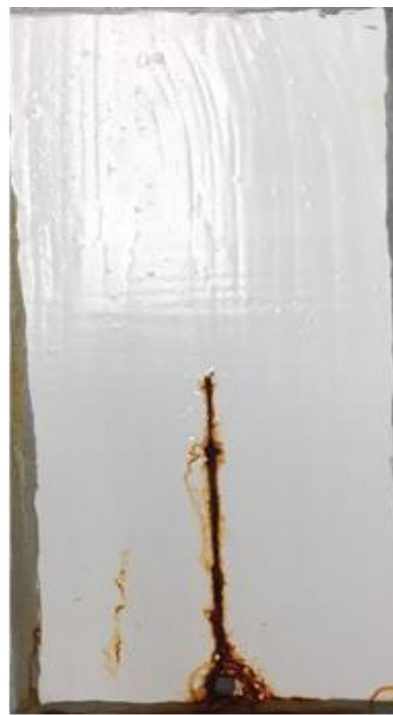
Esmalte A* após 240 horas em nevoeiro salino
