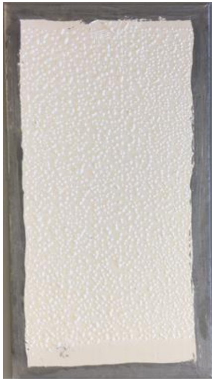
Esmalte Concorrência 2 (C2) após 170 horas em câmara de condensação
