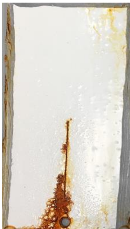
Esmalte G* após 170 horas em nevoeiro salino
