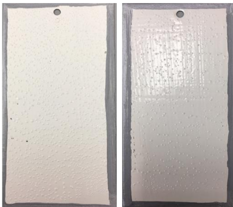
Esmalte B após 170 horas em câmara de condensação
