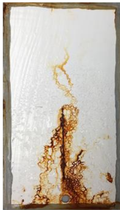
Esmalte A após 240 horas em nevoeiro salino
