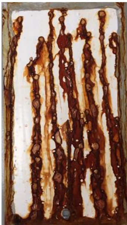
Esmalte I após 170 horas em nevoeiro salino.
