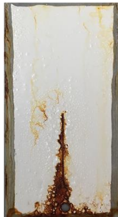
Esmalte G* após 240 horas em nevoeiro salino
