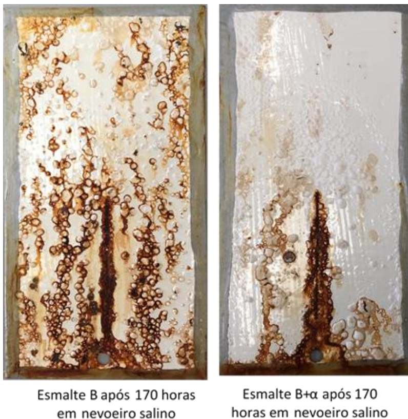
Figura A6.2. Resultados nevoeiro salino para os esmaltes formulados com a resina B.
