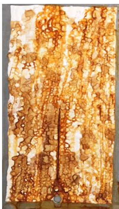
Esmalte F após 170 horas em nevoeiro salino
