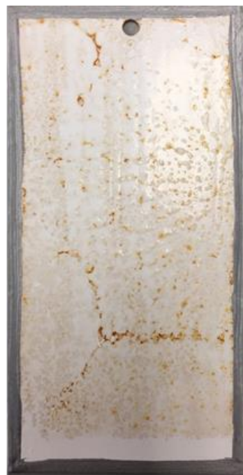
Esmalte D+z após 170 horas em câmara de condensação
