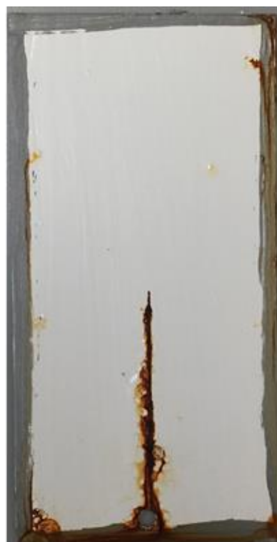
Esmalte Concorrência 1 após 240 horas em nevoeiro salino.
