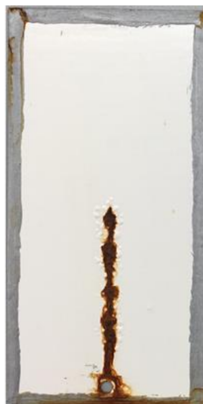
Esmalte Concorrência 2 após 240 horas em nevoeiro salino.
