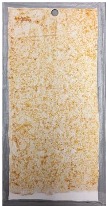
Esmalte D+x após 170 horas em câmara de condensação
