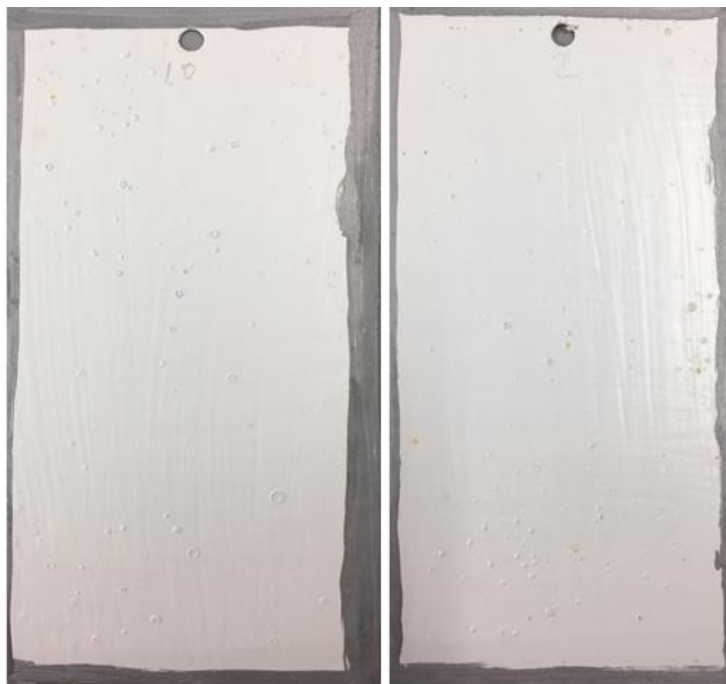
Esmalte A após 170 horas em câmara de condensação
