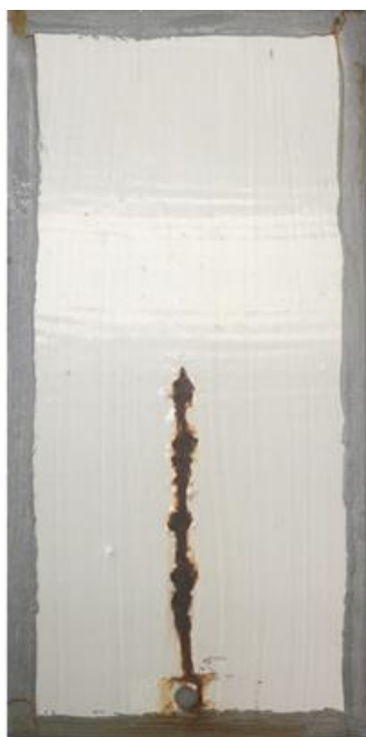
Esmalte Concorrência 2 após 170 horas em nevoeiro salino.
