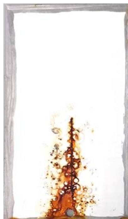
Esmalte H após 170 horas em nevoeiro salino
