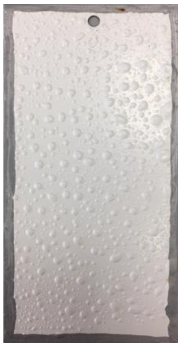
Esmalte D+y após 170 horas em câmara de condensação
