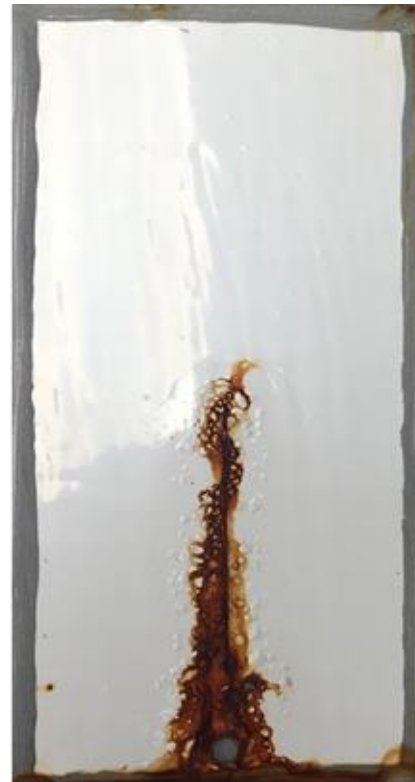
Esmalte G após 240 horas em nevoeiro salino
