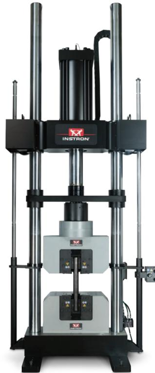
Figura 2.3: Máquina de teste universal hidráulica do modelo KPX da marca Instron
