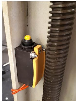
Figura 4.10: Limitador inferior de emergência montado na estrutura
