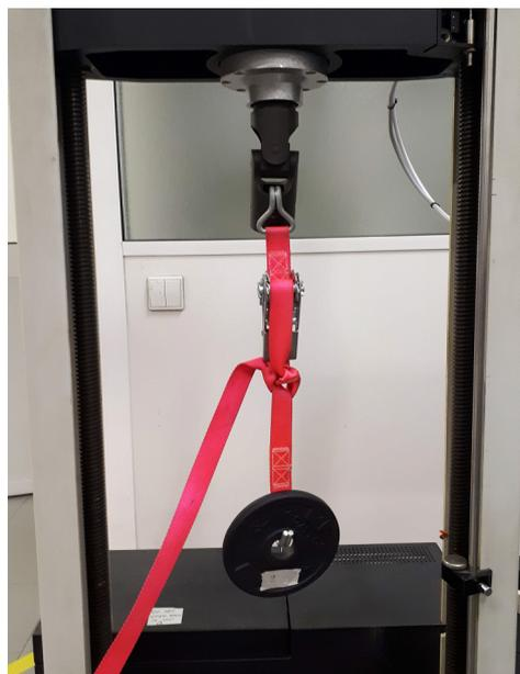
Figura 5.2: Configuração do teste à exatidão da célula
