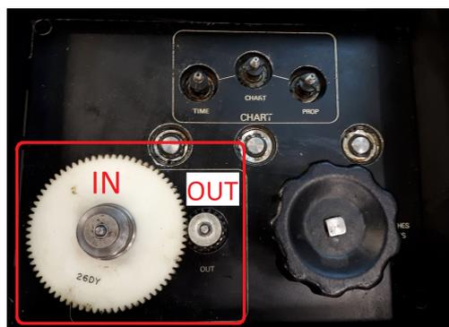
Figura 2.6: Engrenagens que modificam a velocidade do movimento
