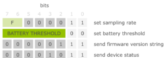
Figura 3.8: Estrutura de comandos genéricos aceites pelo firmware do BITalino .
