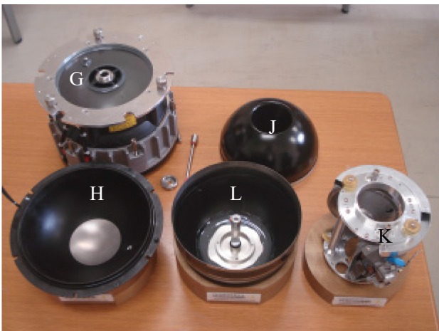
図5 ジャイロ機構部分の取り出し
