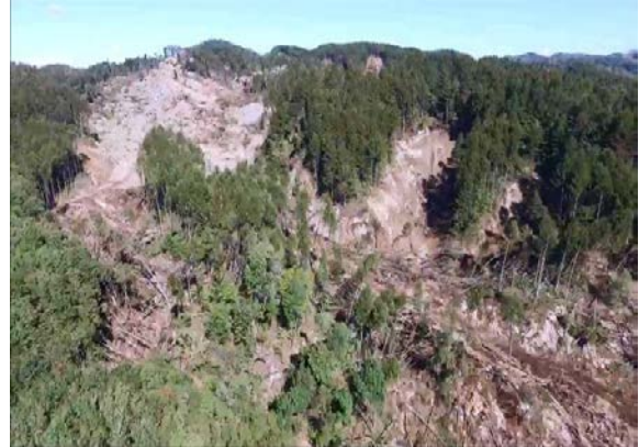
写真 2 日高幌内川大規模岩盤すべり崩壊の状況（ドローンからの空中写真）（苫小牧工業高等専門学校 谷口助教提供）
