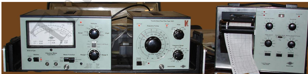
Рис. 3. Комплекс для дослідження інтенсивності зношування за вимірюванням амплітуди акустичного сигналу
