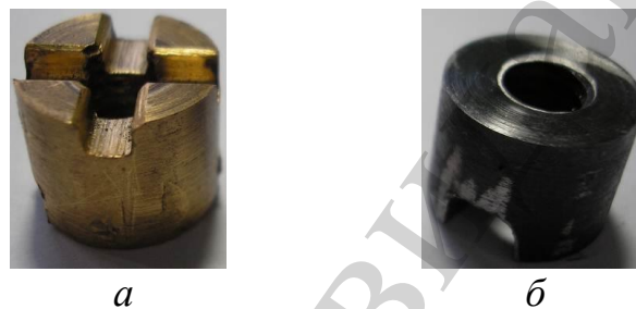
Рис. 2. Зовнішній вигляд експериментальних зразків для випробувань за схемою "кільце-кільце" на машині тертя 2070 СМТ-1: a – С61900 (НВ95); б – А48-25ВС1.25В№.25 (HRC40)
