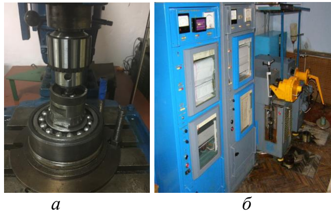
Рис. 1. Загальний вид машин тертя: a – чотирикулькової машини тертя ; б – машини тертя 2070 СМТ-1 з додатковим модулем "кільце-кільце"
