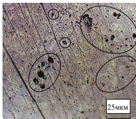
Рис. 7. Включення мікрочастинок в поверхню зразка матеріалу A48-25BC1.25BNo.25 (HRC40)
