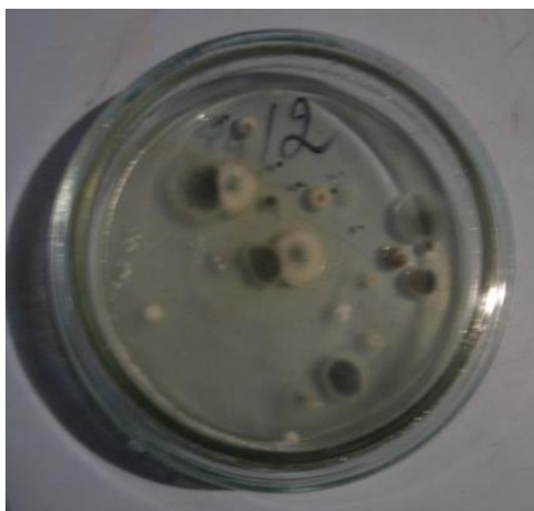
Рис. 9. Колонії грибів Penicillium та Fusarium на середовищі Чапека, виділені з бетону без біоцидних добавок
