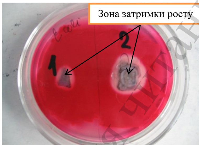
Рис. 7. Зона затримки росту культури Escherichia coli навколо зразків бетону з добавкою
