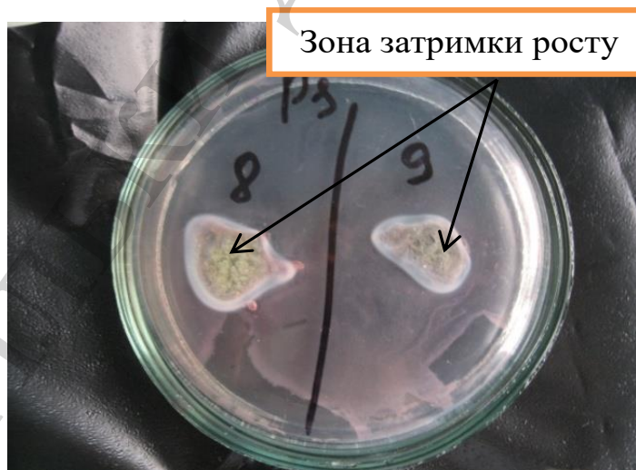
Рис. 8. Зона затримки росту культури Pseudomonas aeruginosa навколо зразків бетону з добавкою
