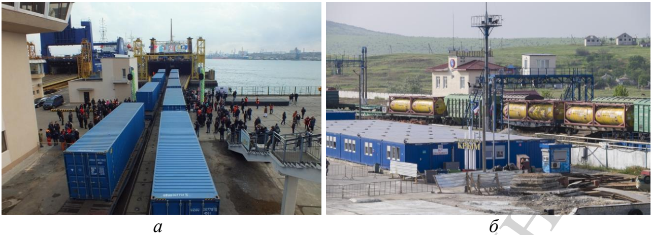
Рис. 1. Завантаження комбінованих поїздів на залізничному поромі: а – з суховантажних контейнерів; б – з контейнерів-цистерн
