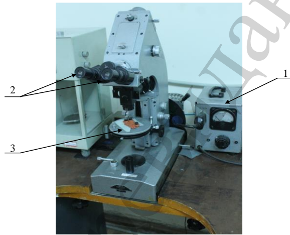
Рис. 6. Оптичний мікроскоп МБИ-6: 1 – блок живлення, 2 – окулярний вузол, 3 – стіл для досліджуваних зразків
