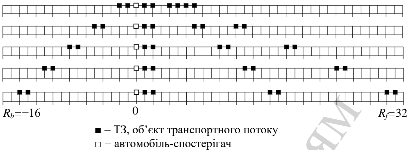
Рис. 2. Схема п'яти кроків імітаційного моделювання кліткового автомату
