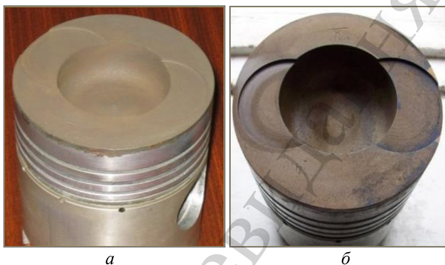
Рис. 10. Поршень КамАЗ-740 с нанесенным покрытием: a – \text{Al}|\text{Al}_2\text{O}_3 \cdot \text{MnO}_y , б – \text{Al}|\text{Al}_2\text{O}_3 \cdot \text{CoO}_x [46]
