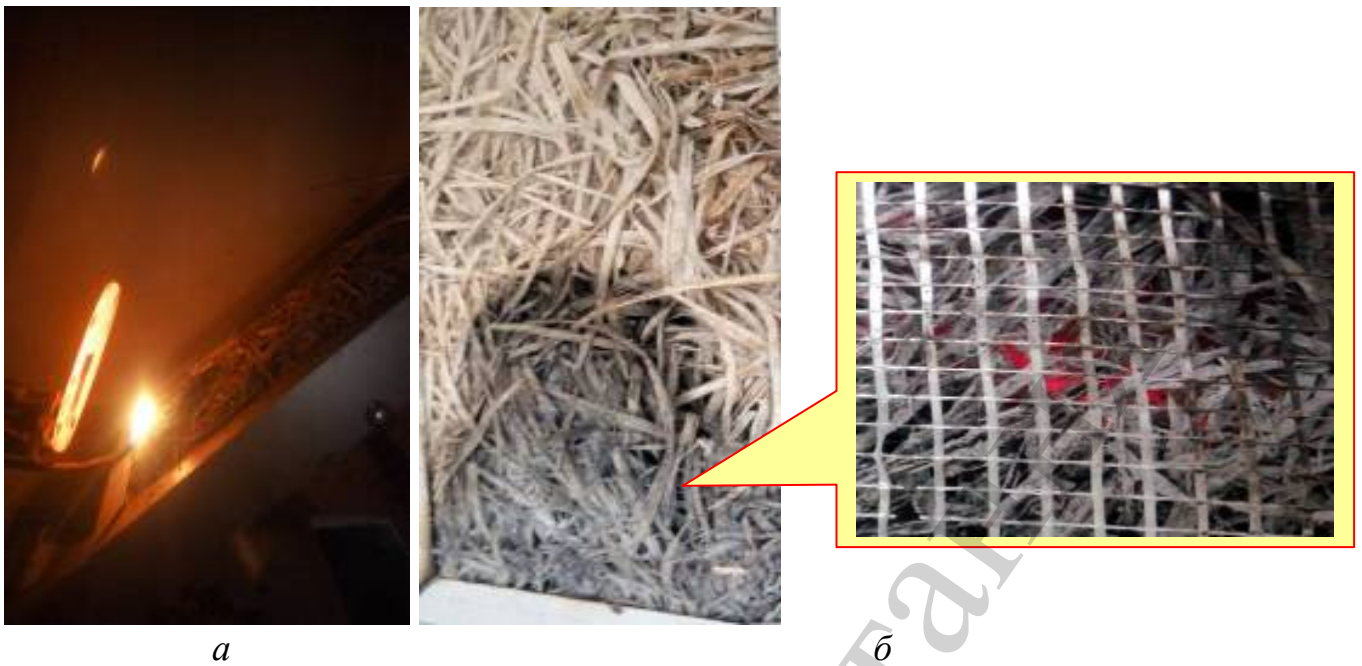
Рис. 3. Результати випробувань процесу займання та поширення полум'я матеріалу: а – вплив полум'я на зразок, б – горіння матеріалу на основі деревної шерсті і неорганічного в'язучого при співвідношенні 1:1
