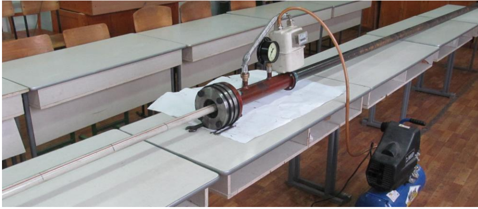
Рис. 17. Експериментальна установка для досліджень динаміки протягування поршнем нового поліетиленового трубопроводу в зношений сталевий
