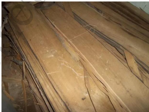
Рис. 6. Необроблений сушений дубовий шпон вологістю W=6\% та масою m_c=4,41 кг
