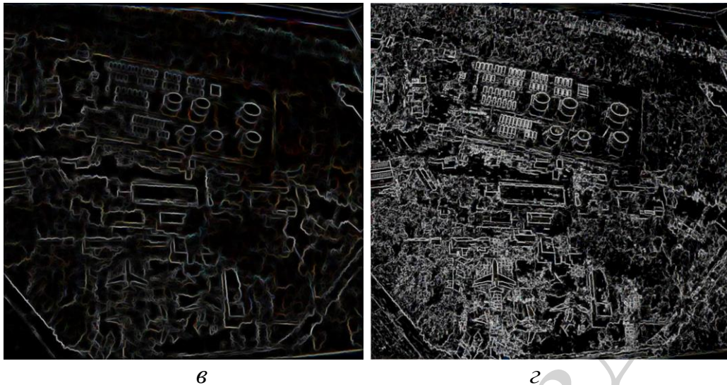
Рис. 7. Результати сегментування вихідного зображення відомими методами: а – метод Otsu; б – метод k -means ( k=2 ); в – метод Random forest; г – мурашиний метод
