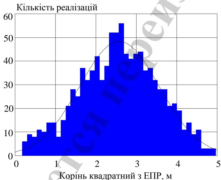
Рис. 7. Гістограма амплітудного множника (квадратного кореня зі значень ефективної поверхні розсіювання) відбитого сигналу
