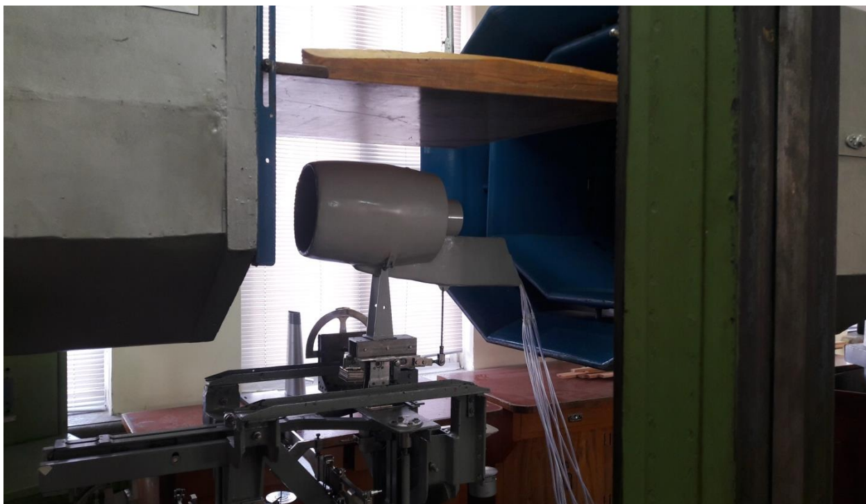
Рис. 1. Фотография внешнего вида рабочей части АДТ Т-1 с моделью двухконтурного двигателя
