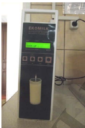
Рис. 1. Прилад з визначення фізико-хімічного складу козиного молока «Екомілк»
