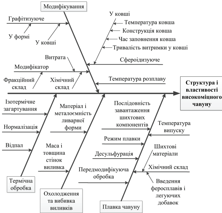
Рис. 3. Діаграма Ішікави для повного циклу виробництва високоміцного чавуну
