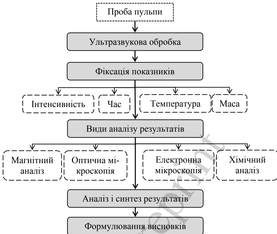
Рис. 1. Загальна схема проведення досліджень ультразвукової обробки проб пульпи
