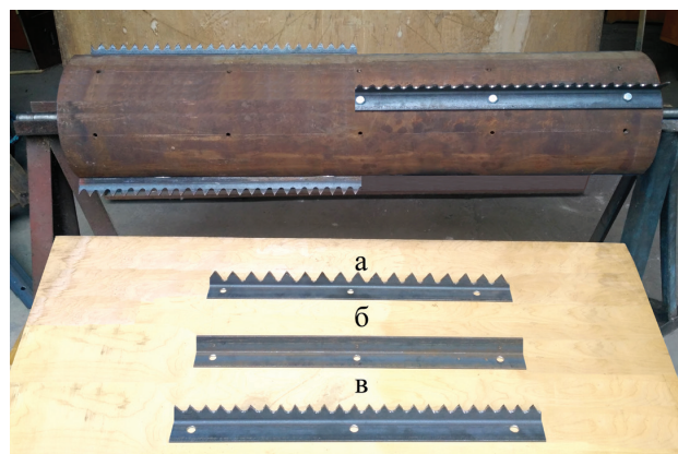
Рис. 1. Проміжний молотильний барабан та варіанти додаткових планок барабану: а – гладкої; б – із зубоподібними профілями з висотою 30 мм; в – із зубоподібними профілями з висотою 20 мм пристрою попереднього обмолоту зерна
