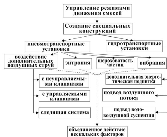
Рис. 3. Схема реализации процессов интенсификации в трубопроводном транспорте
