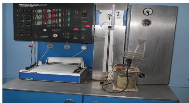
Рис. 5. Вигляд приладу з визначення амінокислотного складу контрольної та дослідних партій кефіру
