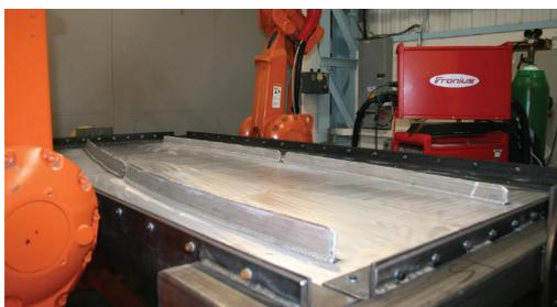
Рис. 9. Изготовление алюминиевой конструкции крыла самолета [18]
