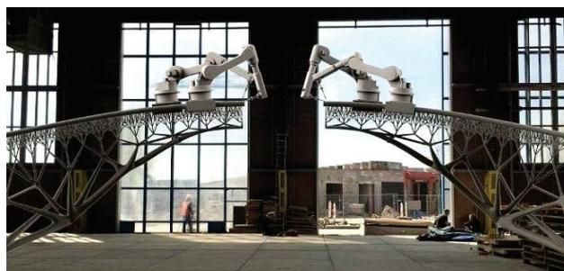
Рис. 13. Процесс изготовления моста с помощью сварочного 3D-принтера [25]
