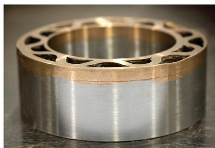
Рис. 7. Объемная пустотелая деталь с внутренними ребрами жесткости из биметалла «конструкционная сталь – бронза Cu-3 %Si», полученная с помощью технологии электродуговой наплавки токоведущей проволокой [16]
