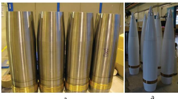
Рис. 6. Изготовление сложнопрофильных деталей с переменной толщиной стенки из высокопрочных сталей на примере корпуса снаряда (высота – 800 мм, диаметр – 160 мм, толщина стенки 18–8 мм, масса – 32 кг, производительность – 4 кг/час) [16]: а – начальный этап; б – цилиндрический участок; в – конический участок; г, д – готовые детали
