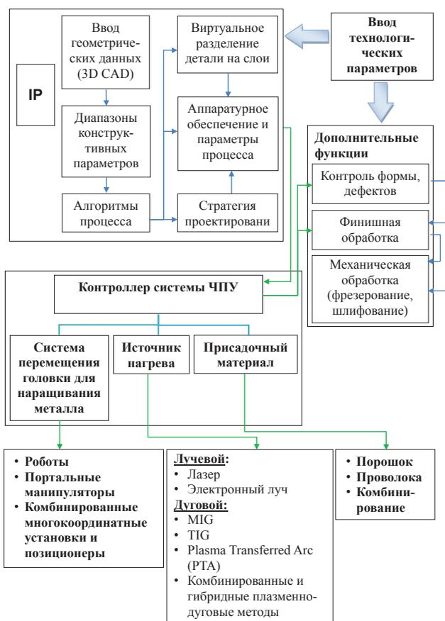
Рис. 1. Принципиальная аппаратно-структурная схема процессов получения объемных металлических изделий послойным аддитивным наращиванием на основе сварочных технологий
