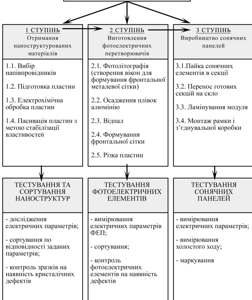
Рис. 3. Технологічні етапи виробництва сонячних панелей на основі наноструктурованих напівпровідників
