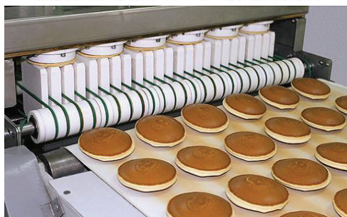
Рис. 6. Ділянка технологічної лінії виробництва кондитерських виробів «ПанКейк» з сирною начинкою (промислове виробництво на ТОВ ПКГ «Лісна казка», м. Харків)
