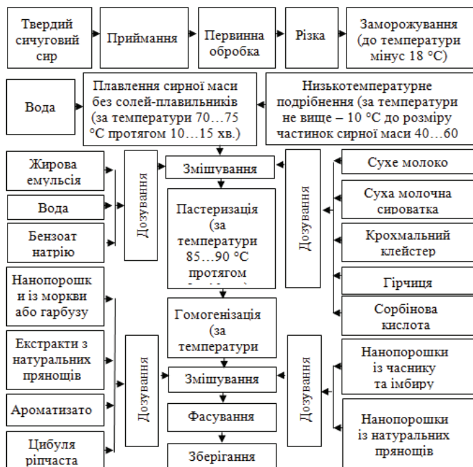
Рис. 5. Принципова технологічна схема виробництва сирних плавлених продуктів з використанням заморожування, дрібнодисперсного подрібнення та нанопорошків із прянощів, прямих та каротинвмісних овочів
