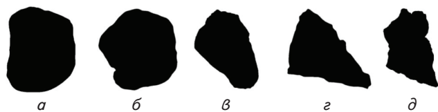
Рис. 7. Абразивні частинки із відомою абразивною здатністю [6, 15]: а – кремній; б – граніт; в – SiC; г – кварц; д – Al 2 O 3
