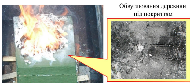
Рис. 6. Результати випробувань модельного зразка, обробленого вогнезахисним покриттям на неорганічній основі
