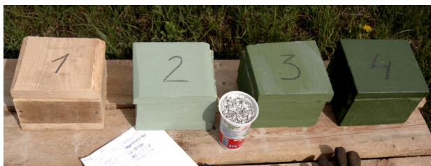
Рис. 1. Модельні зразки дерев'яних конструкцій: 1 – необроблений, 2 – оброблений вогнезахисним покриттям на органо-мінеральній основі; 3 – оброблений вогнезахисним покриттям на неорганічній основі [9]; 4 – оброблений вогнезахисним геоцементним жаростійким покриттям з тепловідбивним екраном
