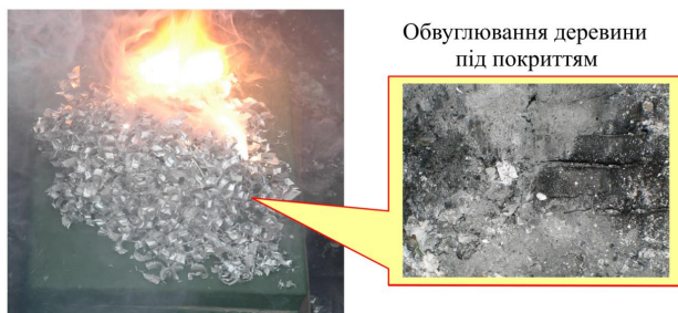
Рис. 7. Результати випробувань модельного зразка, обробленого геоцементним жаростійким покриттям з тепловідбивним екраном
