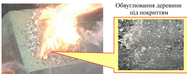
Рис. 5. Результати випробувань модельного зразка, обробленого органо-мінеральним захисним покриттям
