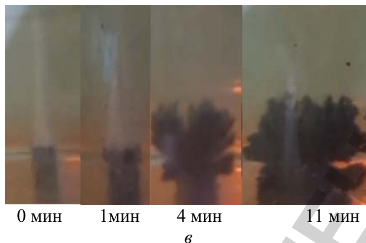
Рис. 4. Рост осадка на катоде (раствор \text{CuSO}_4 в воде) при: a – \text{pH}=3.95 ; сила тока процесса I=140 \text{ mA} , C(\text{Cu})=0,156 \text{ моль/л} ; б – \text{pH}=3.65 ; сила тока процесса I=200 \text{ mA} , C(\text{Cu})=0,156 \text{ моль/л} ; в – \text{pH}=4,35 ; сила тока процесса I=200 \text{ mA} , C(\text{Cu})=0,08 \text{ моль/л}
