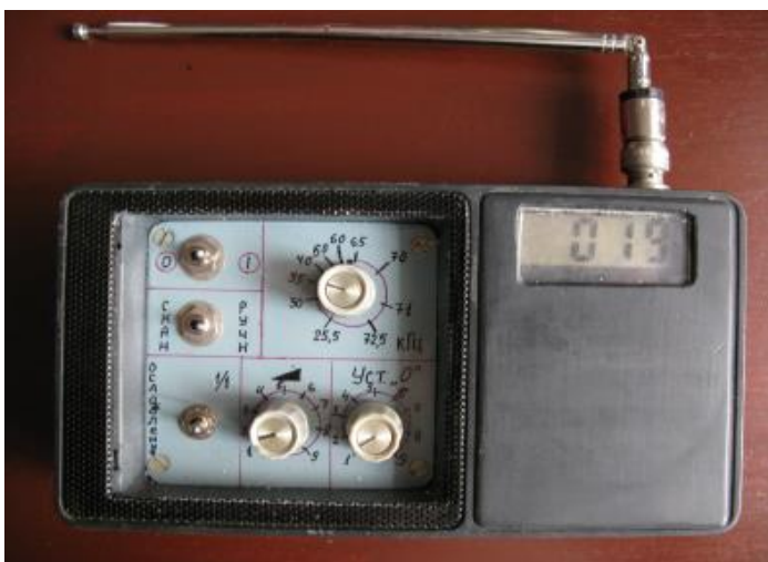
Рис. 1. Внешний вид измерителя напряженности E-составляющей ЭМП и рабочий момент с прибором
