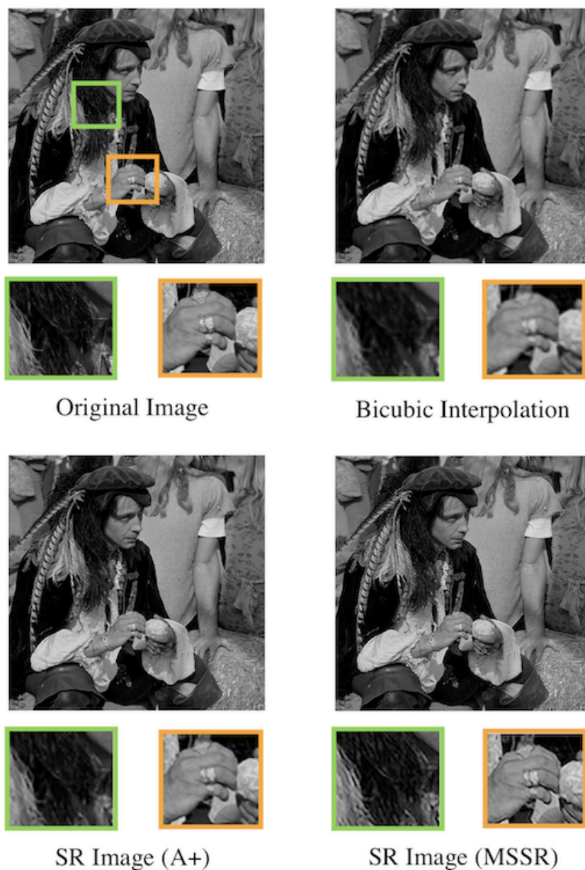
図 3.3 マルチステップ超解像技術による実験結果 (A+ to SRCNN)
